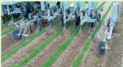
Rampe de traitement localisé et bineuse, toutes deux adaptées à la culture de carottes sur planches.
