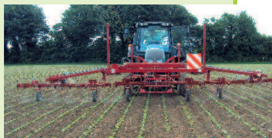
Rampe de traitement composée de 3 parties indépendantes, guidées chacune par des sillons tracés dans le sol lors du semis où les roues viennent se placer.
