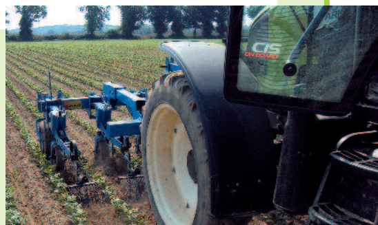
Bineuse équipée de socs "patte d'oie" suivis de petites herse permettant d'émietter la terre, de la niveler et de déchausser davantage les adventices.
