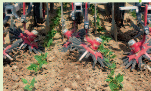
Bineuse équipée de moulinets, guidée par caméra.
