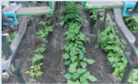
Bineuse Garford guidée par caméra, équipée de 2 lames "Slash" travaillant le long du rang et d'une dent centrale en cœur.
